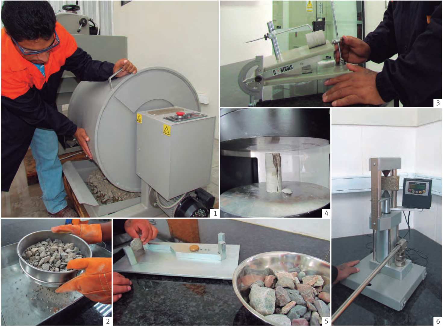
1- Ensayo de abrasión (Los Ángeles) / Los Angeles abrasion test 2- Análisis granulométrico por tamizado / Granulometric analysis by sieving 3- Ensayo Tilt Test en rocas / Tilt test 4- Compresión uniaxial de rocas / Unconfined compressive strength of rocks 5- Partículas chatas y alargadas / Flat and elongated particles test 6- Ensayo de carga puntual en rocas / Point load test in rocks
