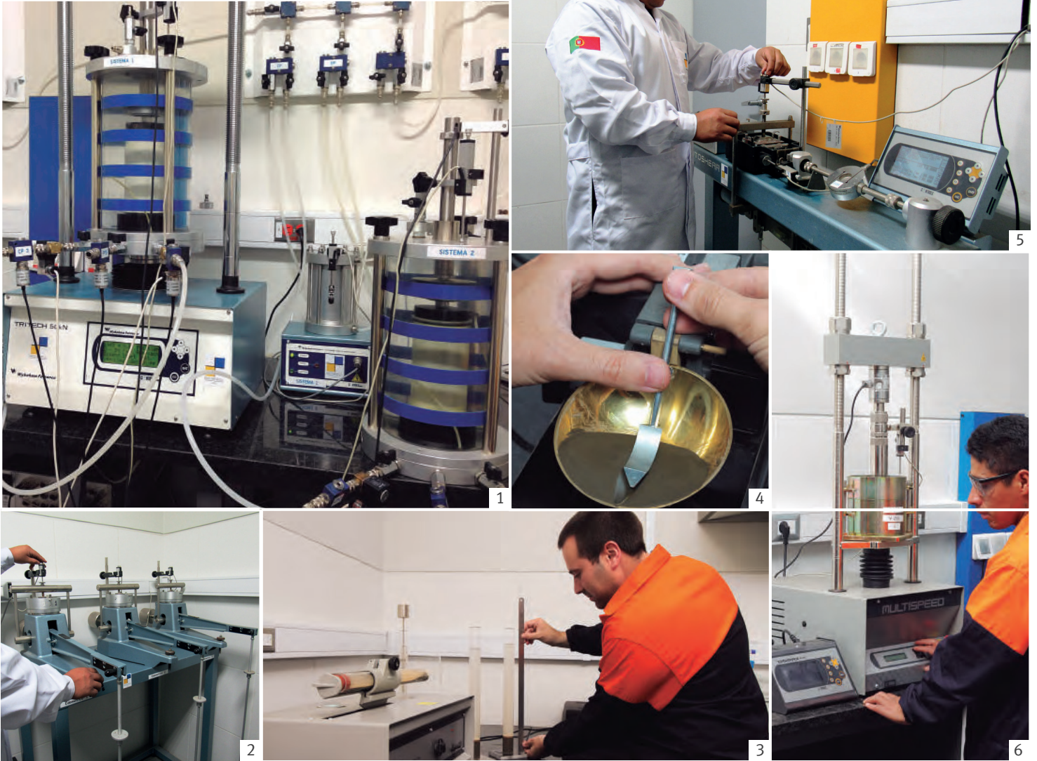
1- Ensayo triaxial / Triaxial test 2- Ensayo de consolidación edométrica / Oedometric consolidation test 3- Ensayo de equivalente de arena / Sand equivalent test 4- Límite líquido / Liquid limit 5- Ensayo de corte directo / Direct shear test 6- Ensayo CBR / CBR test
