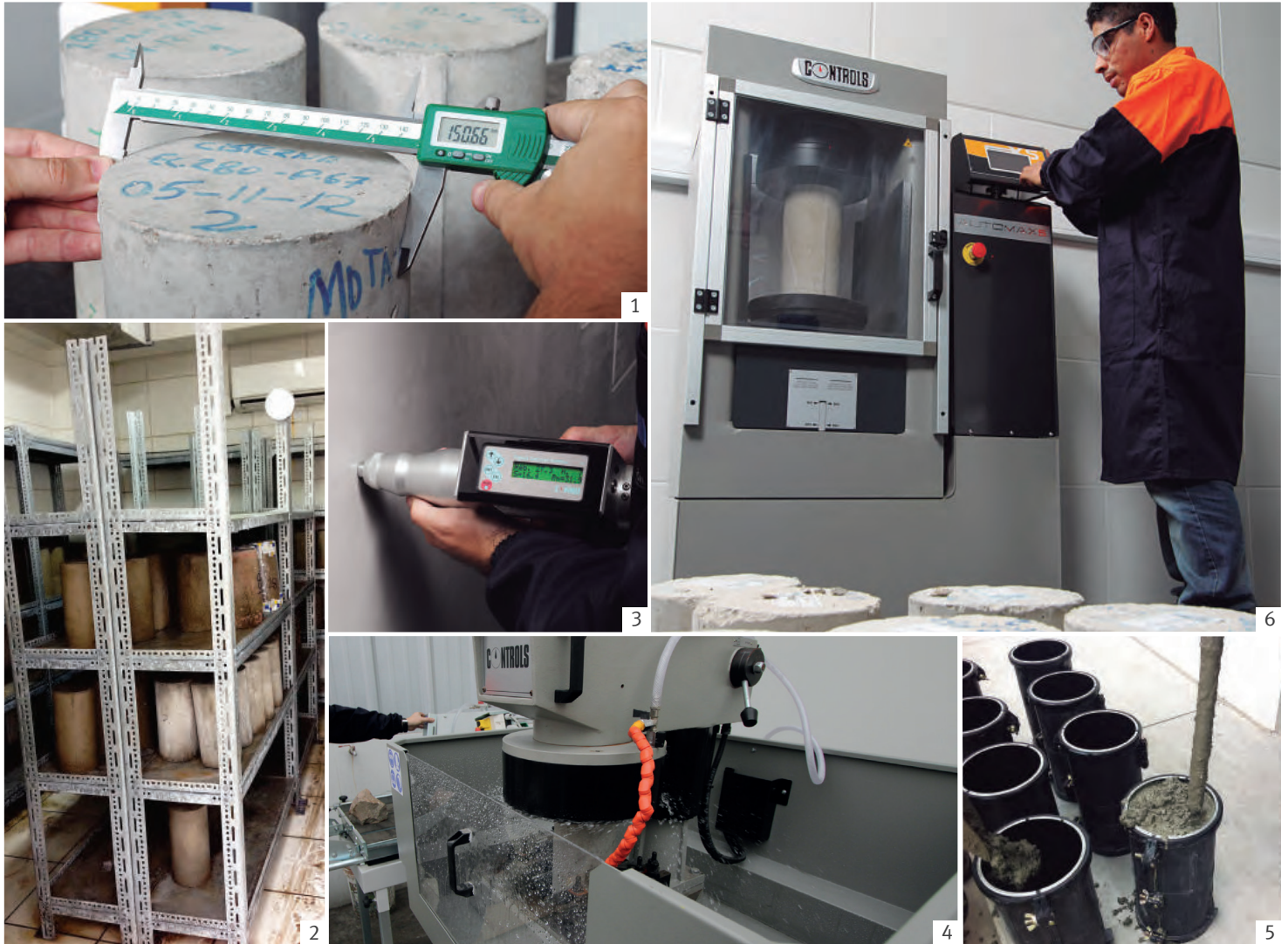
1- Medición de probetas de concreto / Dimension of concrete samples 2- Cámara de curado / Curing chamber 3- Ensayo de esclerometría / Rebound number of hardened concrete 4- Rectificación de probetas de concreto / Grind and polish of concrete specimens 5- Diseño de mezclas de concreto / Concrete design 6- Ensayo de compresión de probetas de concreto endurecido / Compressive strength of hardened concrete
