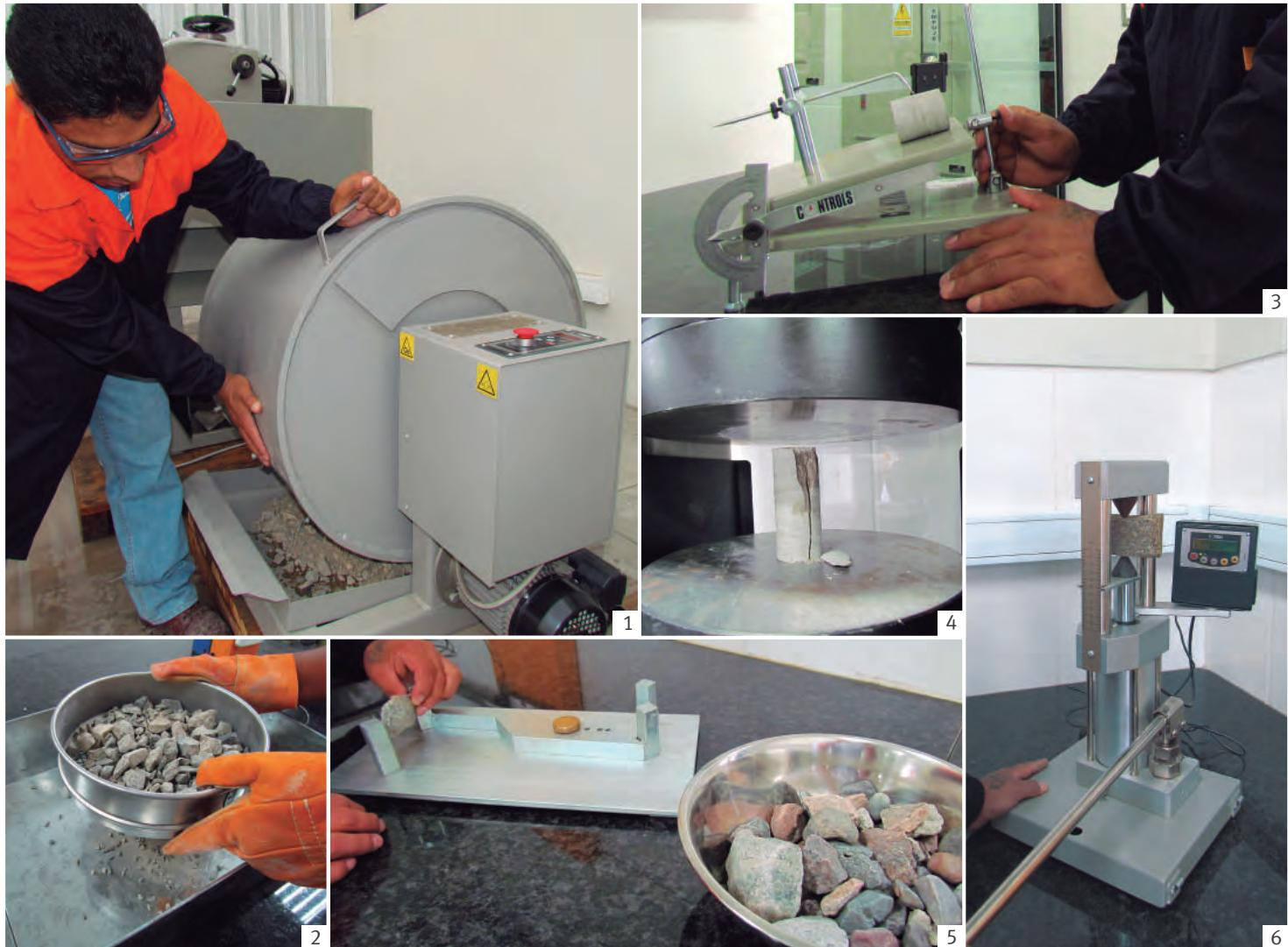
1- Ensayo de abrasión (Los Ángeles) / Los Angeles abrasion test   2- Análisis granulométrico por tamizado / Granulometric analysis by sieving
