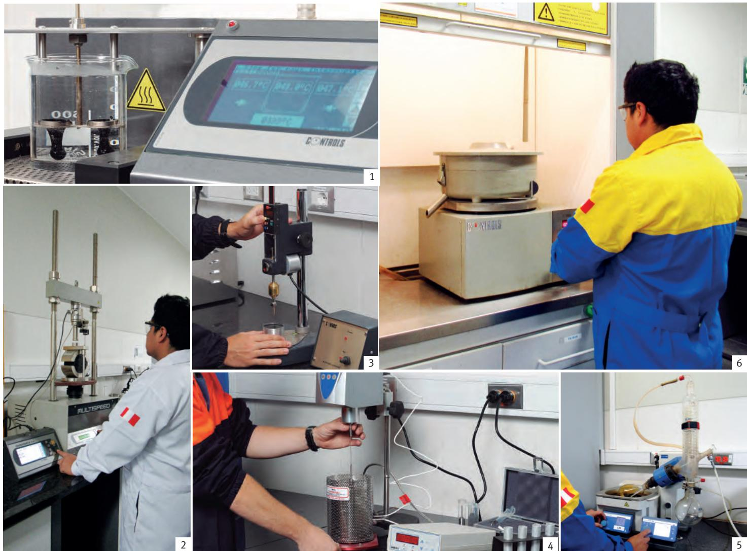
1- Ensayo de punto de reblanecimiento del betún / Softening point of bitumen 2- Ensayo Marshall / Marshall test 3- Ensayo de penetración de materiales bituminosos / Penetration of bituminous material 4- Viscosidad de Brookfield/ Brookfield viscosity 5- Recuperación del betún por evaporación rotativa / Recovery of asphalt through rotary evaporation 6- Porcentaje de betún por centrifugación / Percentage of bitumen by centrifuging
